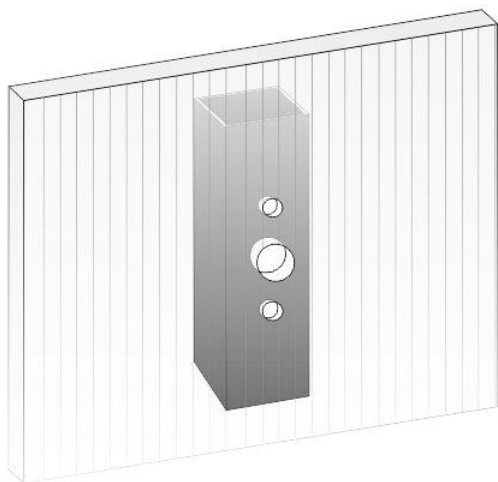
Рис № 4. Подготовка отверстий.
